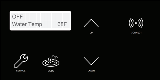
Figure 98. Réinitialisation du Wi-Fi – maintenez la touche CONNECT enfoncée
