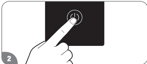
Mettez le chauffe-eau à l'arrêt en appuyant sur le bouton POWER ON/OFF du thermostat externe.
