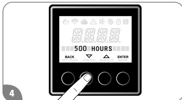
Le réglage d'usine "500 Hours". Une alerte d'entretien se déclenche environ toutes les 500 heures. Appuyez sur le bouton "▼" ou "▲" pour sélectionner "500 Hours", "750 Hours" ou "1000 Hours" et appuyez sur le bouton "ENTER".
