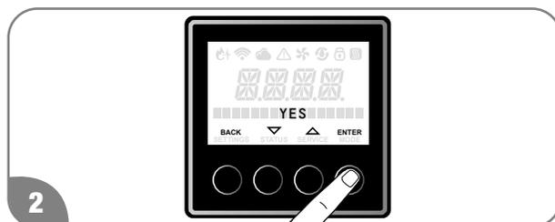
Dans le sous-menu « Flush-Heater? » faites défiler jusqu'à « YES » et appuyez sur « ENTER » pour confirmer la sélection. Cela activera le mode Rinçage.
