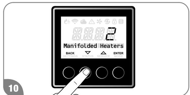
Appuyez sur le bouton “▼” ou “▲” pour sélectionner le nombre de chauffe-eau raccordés et appuyez sur le bouton “ENTER” pour confirmer.
