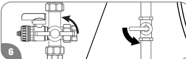
Ouvrez les robinets d'arrêt manuels situés sur les conduites d'alimentation en gaz et en eau du chauffe-eau.
