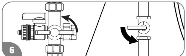
Ouvrez les robinets d'arrêt manuels situés sur les conduites d'alimentation en gaz et en eau du chauffe-eau.
