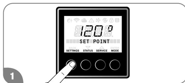
Pour sélectionner le mode Rinçage, appuyez sur « SERVICE » et faites défiler les sélections à l'aide des deux boutons du milieu jusqu'à « FLUSH HEATER? ». Appuyez sur « ENTER » pour confirmer la sélection.
