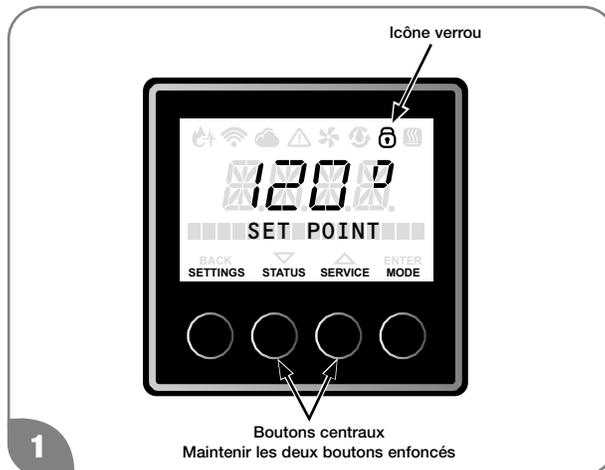
Il faut d'abord déverrouiller l'affichage avant de pouvoir modifier les réglages. Appuyez et maintenez enfoncés les deux boutons centraux jusqu'à ce qu'un bip se fasse entendre. Une fois l'écran déverrouillé, il est possible d'accéder aux menus "SETTINGS", "STATUS" ou "SERVICE".
