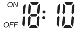
Vùng hiển thị Đồng hồ/ Bộ hẹn giờ và biểu tượng “ON”, “OFF”
