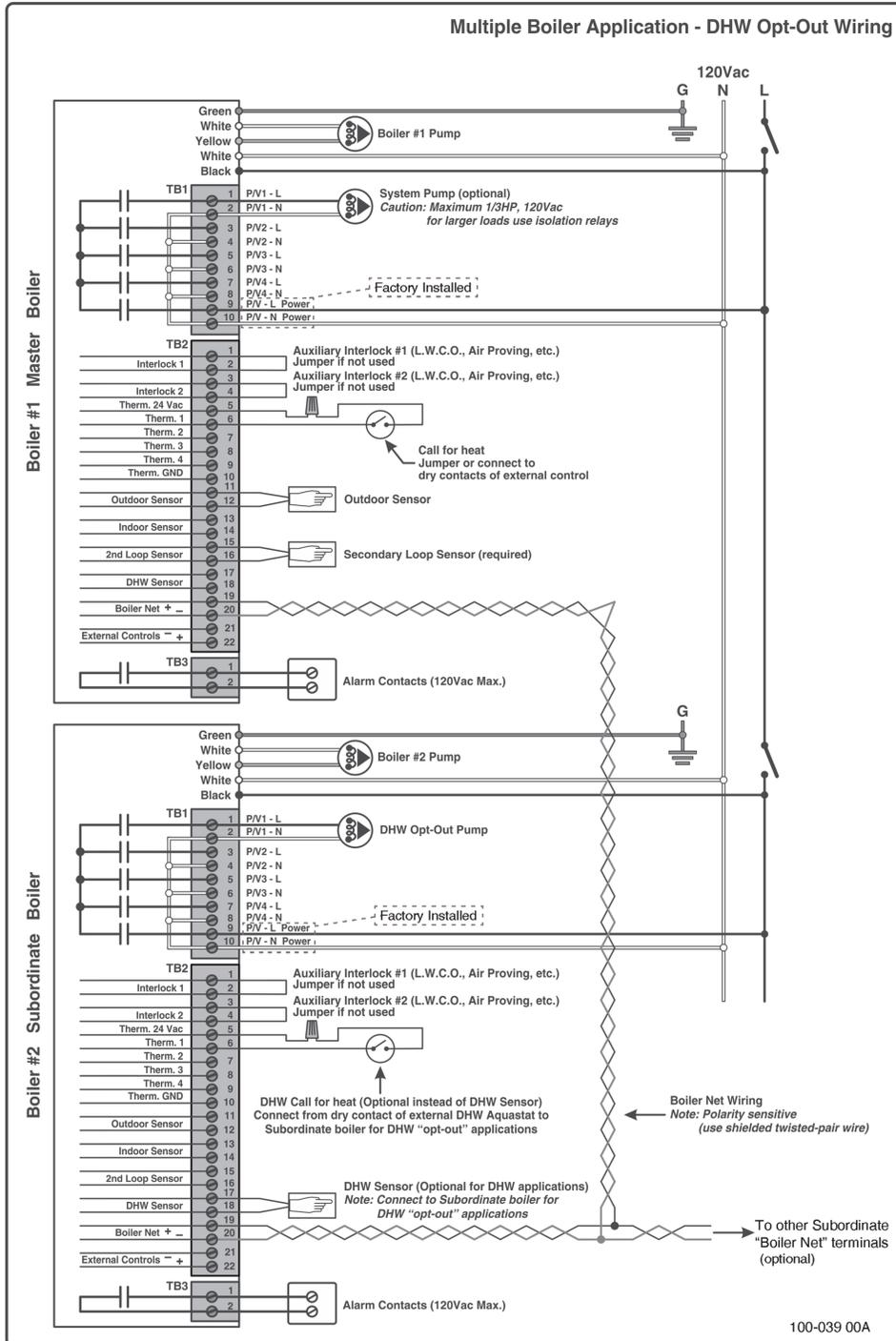
Figure 22 Opt Out DHW wiring diagram
