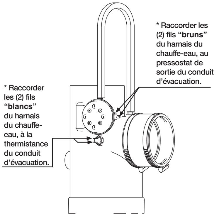
\* En cas de raccordement électrique erroné, le chauffe-eau ne fonctionne pas et affiche le message d'erreur suivant: A018 Flue Temp Sensor Open, Check Wiring.
