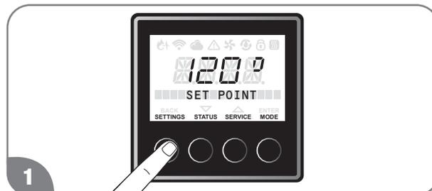
Para entrar al modo descarga, presione "SERVICE" y desplácese hacia arriba o hacia abajo utilizando los botones del centro hasta encontrar el sub-menú "FLUSH HEATER?". Presione "ENTER" para confirmar.
