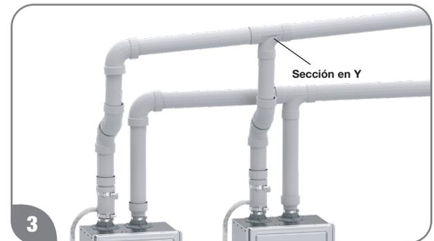
Conecte tuberías de PVC de 3 pulgadas mediante una conexión en T o una conexión en Y. Posteriormente instale tuberías de ventilación hasta terminar en una pared hacia el exterior como se indica en otra sección de este Manual.
