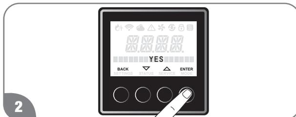
Una vez que se encuentre en "Flush-Heater?", desplácese hacia arriba o hacia abajo y seleccione "Sí" después presione "ENTER" para confirmar. Esto activará el modo de descarga.
