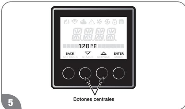
5 Ahora pulse el botón "▼" o el "▲" del centro de la pantalla para aumentar o disminuir la temperatura. La temperatura puede cambiarse en aumentos de 1°F.
