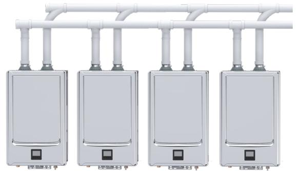
Estos calentadores admiten el uso de sistemas de ventilación comunes, pero se requieren materiales de ventilación específicos. Estos calentadores solo se pueden ventilar con PVC/CPVC Schedule 40 o con las piezas de ventilación InnoFlue. Consulte la sección InnoFlue de este manual para conocer estas piezas y kits específicos.
