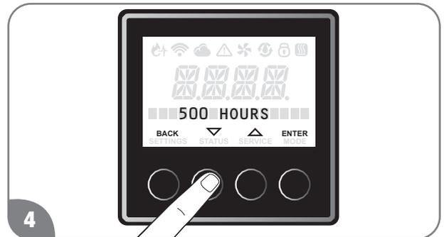
El ajuste de fábrica es "OFF". Pulse el botón "▼" o el "▲" para elegir entre "500 Hours", "750 Hours" o "1000 Hours" de tiempo de combustión para la alerta de servicio y pulse el botón "ENTER" para confirmar.
