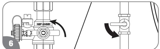
6 Abra las válvulas de agua y gas al calentador..
