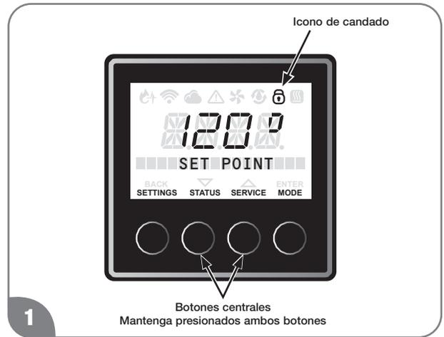
Es necesario desbloquear la pantalla para poder cambiar la configuración. Mantenga pulsados los dos botones del centro hasta escuchar un pitido. Una vez desbloqueada, podrá acceder a los menús "SETTINGS", "STATUS" or "SERVICE".
