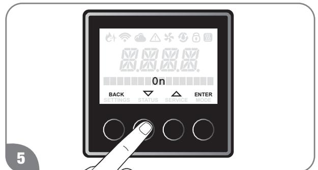
5 La configuración de fábrica es "Off" (apagado). Pulse el botón "▼" o el "▲" para seleccionar "On" y pulse el botón "ENTER" para confirmar. Para salir de esta configuración pulse el botón "Back" hasta que se muestre la pantalla inicial.
