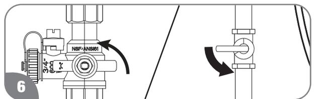
Permita el paso de gas y agua al calentador abriendo las válvulas.
